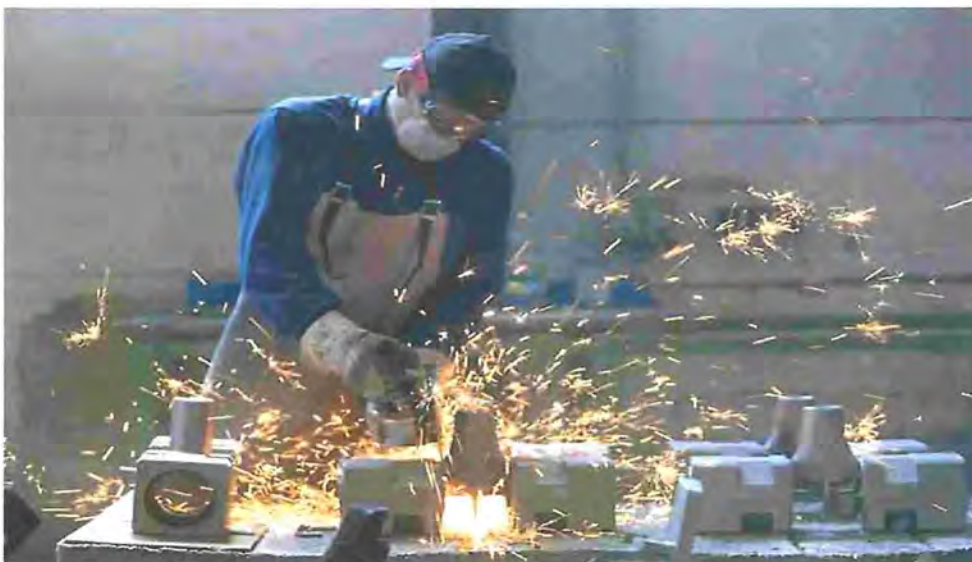
Abbildung 8 Abtrennen der Anschnitte des Gussprodukts
