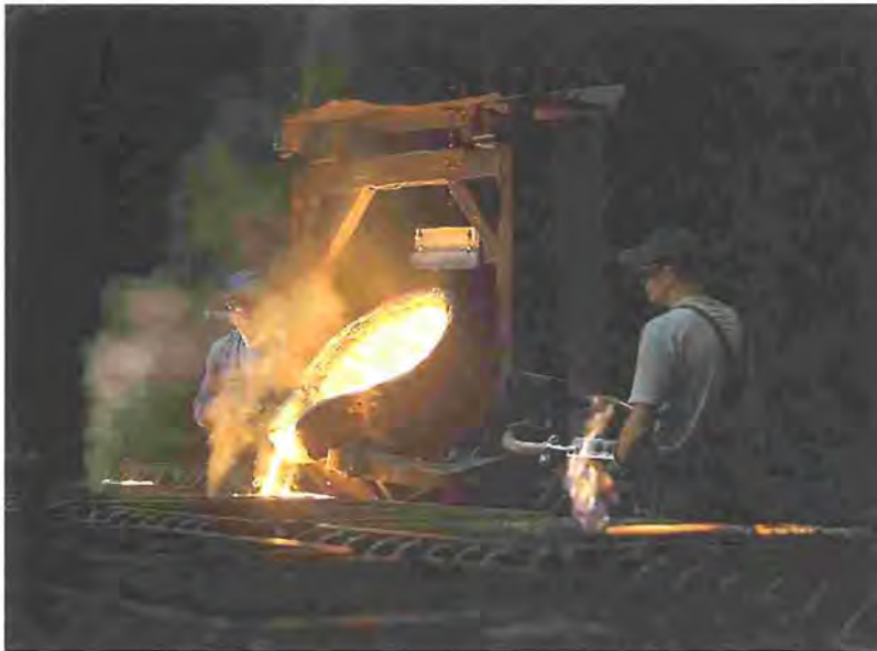
Abbildung 7 Abgießen der Formen in der Formanlage
