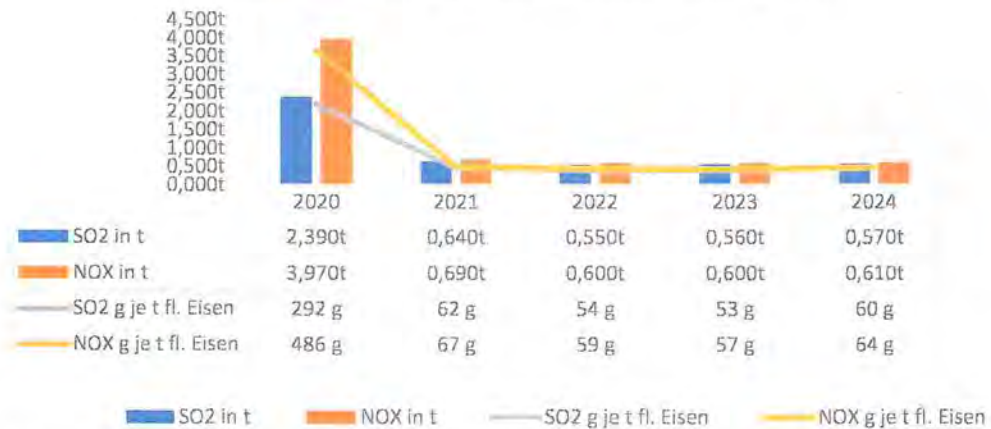
Abbildung 24: Entwicklung SO 2 und NO x Emissionen (absolut und spezifisch je t Flüssigeisen)
